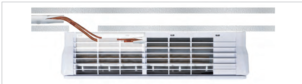
Obr. 27: Připojení vnitřní jednotky při montáži vedení chladiva pod omítkou (pohled shora)
