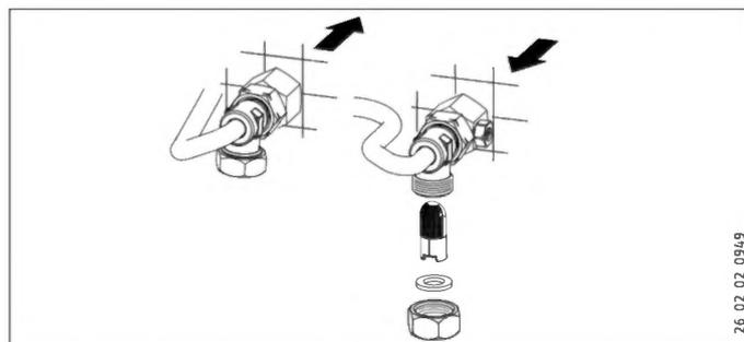
V případě znečištění očistěte sítko ve šroubení přípojky studené vody. Uzavřete uzavírací ventil v přívodu studené vody, než sítko vyjmete, očistíte a opět namontujete.
