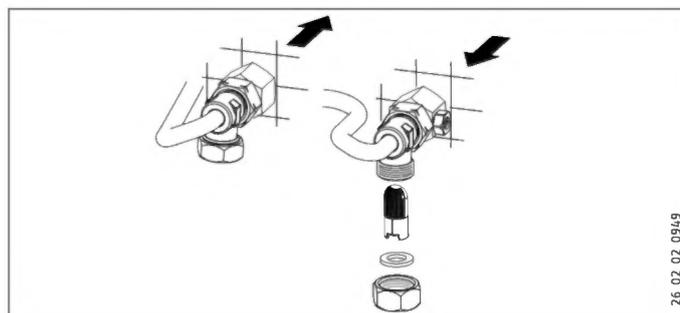
W razie zabrudzenia, oczyścić sitko w przyłączy zimnej wody. Podłączyć zawór odcinający przewodu doprowadzającego wody
