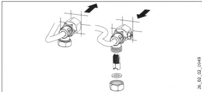
В случае загрязнения следует очистить сетчатый фильтр в резьбовом соединении подачи холодной воды. Закрыть запорный вентиль в трубопроводе подачи холодной воды, демонтировать сетчатый фильтр, очистить его и установить снова.
