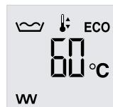
При индикации ограничений в меню появляются символы разогрева, образования накипи и технического обслуживания / неисправностей, как описано в главе «Настройки / элементы управления и стандартная индикация».
