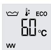
V zobrazení při omezení nabídky se objeví symboly ohřevu, zanesení vodním kamennem a servis / chyba, jak je popsáno v kapitole „Nastavení / ovládací prvky a standardní zobrazení“.
