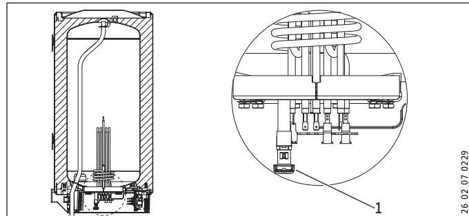
1 Kołpak zaworu spustowego
