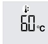
Tlačítka Plus a Minus nastavte požadovanou teplotu od 20 do 85 °C (nastavení z výroby).
