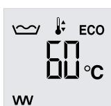
V indikácii pri obmedzení menu sa objavujú symboly ohrevu, zavápnenia a servisu/chyby, tak ako je popísané v kapitole Nastavenia / Ovládacie prvky a štandardná indikácia.
