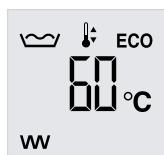
We wskazaniu przy ograniczeniu menu wyświetlane są symbole nagzewania, zwapnienia oraz Serwis/Błąd, jak opisano w rozdziale „Ustawienia / Elementy obsługi i wyświetlacz standardowy”.
