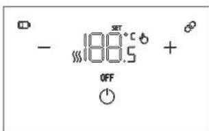
Když se termostat poprvé spustí, všechny symboly se rozsvítí po dobu asi tří sekund, pak termostat přejde do režimu ON.
