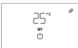
Termostat aktivuje ochranný režim (OFF), když se v režimu ON dotknete tlačítka ochranného režimu. Na displeji se zobrazuje OFF. Pokud teplota klesne pod 8 °C, termostat automaticky aktivuje výstup vytápění, dokud teplota nedosáhne 8 °C.
