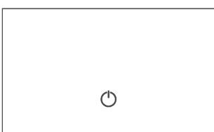
Po 20 sekundách nečinnosti přejde termostat do klidového režimu. Displej se vypne. Předchozí nastavení požadované teploty a provozní režim (AUTO, ruční nebo ochranný režim) pracuje na pozadí. Termostat probudíte stisknutím tlačítka pohotovostního režimu.
